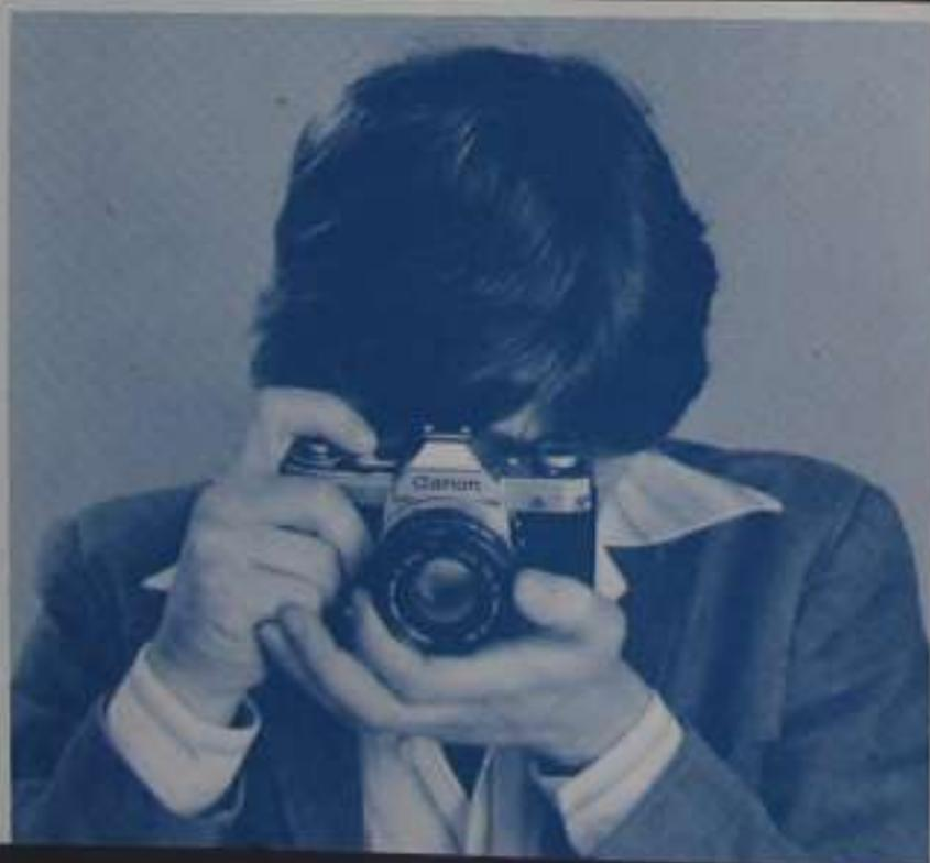
leggero. Quando premete il pulsante, cercate di stringerlo gentilmente col dito. Evitate di «colpirlo» o di premerlo improvvisamente, soprattutto quando si usa una velocità di otturazione lenta, e ciò per evitare di rendere mossa la fotografia.
