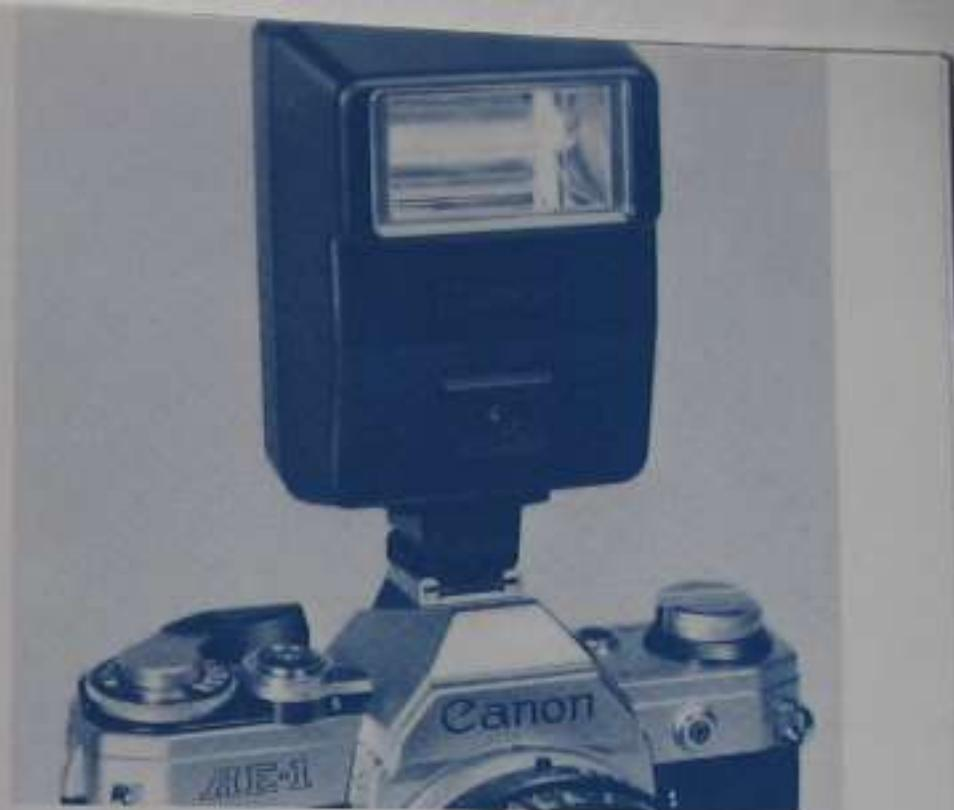
misurazione della luce a tutta apertura, la fotografia col flash automatico può essere eseguita regolando manualmente sull'obiettivo il prescritto f/stop. In entrambi i casi, la velocità di otturazione viene regolata automaticamente sul valore di sincronizzazione X di 1/60 secondo.
